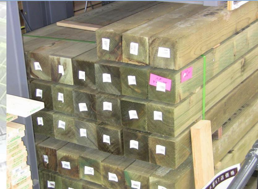
Панели NOZOMI HBF, элементы стоек и балок производятся из одного и того же конструкционного материала - бруса 100 x 100 мм
